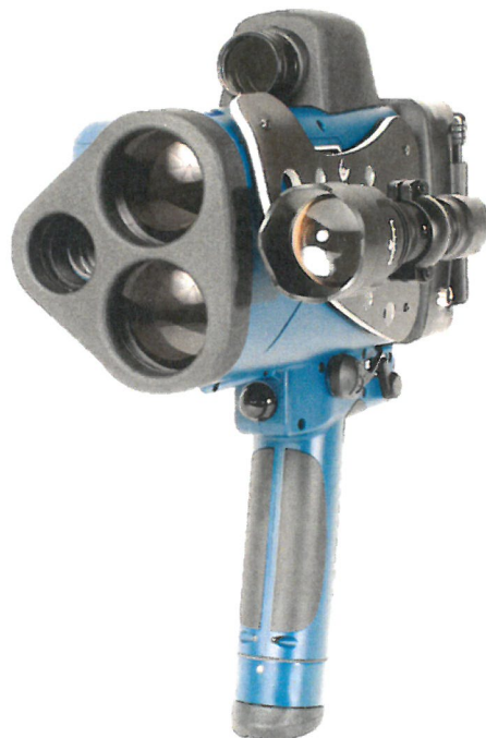
Rys. 3 Widok przyrządu z oświetlaczem podczerwieni IR w uchwycie mocującym
